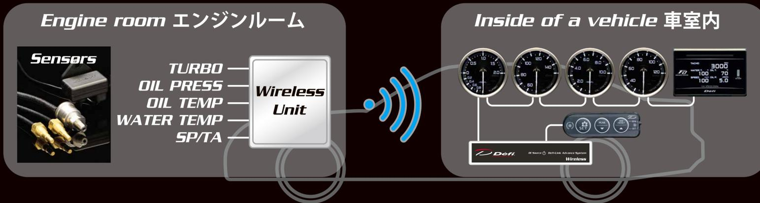
最も作業が面倒なエンジンルームから車室内へのワイヤーハーネス配線をワイヤレス化するユニット。
