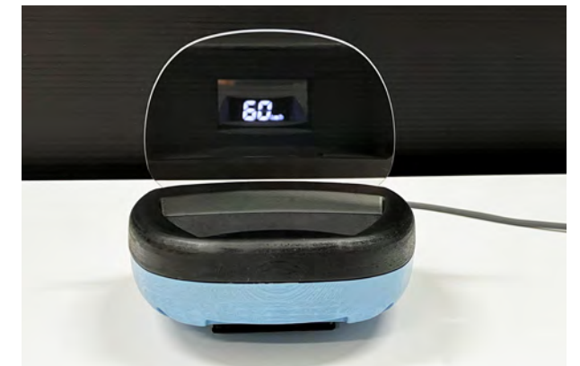
後付けヘッドアップディスプレイ(開発品)
